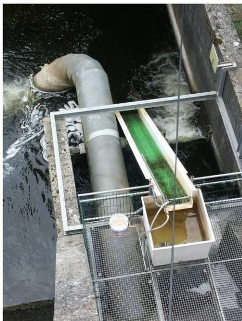
Fig. 8 : Vue de dessus de la passe-piège à anguilles de Moulin Neuf sur la Rivière de Pont l'Abbé
